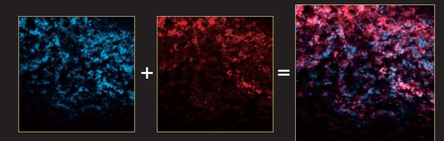
励起波長: 561nm(mCherry)、785nm(IRDye800CW 2-DG) 蛍光フィルターの中心波長: 595nm(mCherry)、832nm(IRDye800CW 2-DG) 対物レンズ: CFI Plan Apo λ 20×
