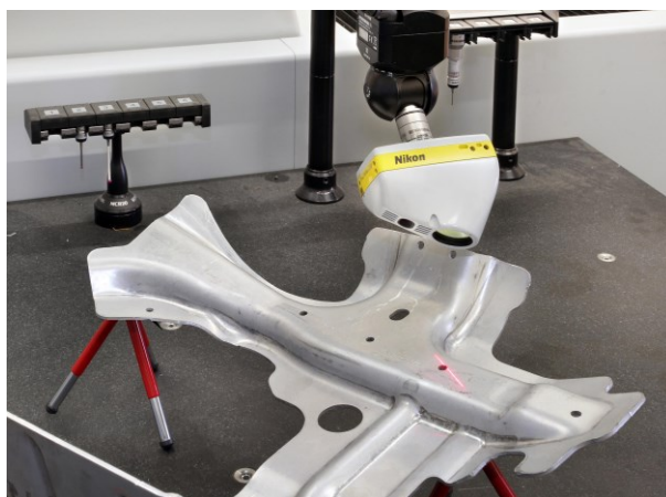
■ LC 15Dx レーザースキャナーヘッドを使った、JLR 社向け試作プレス部品の検査
