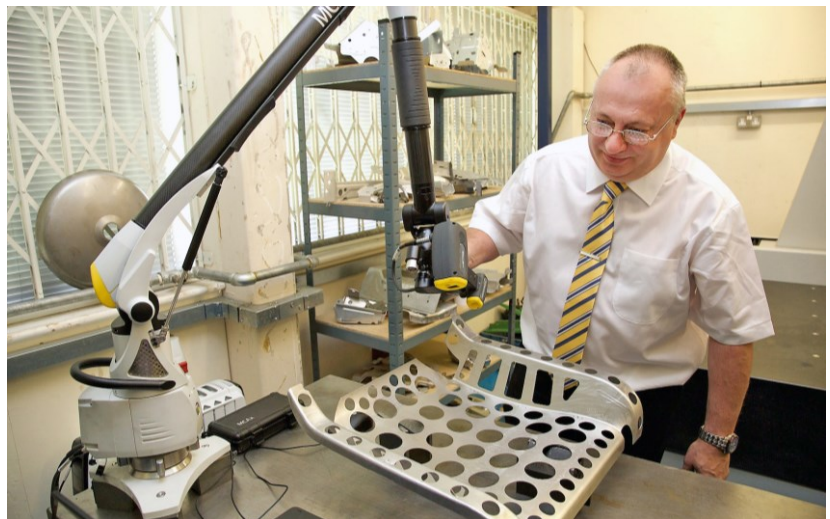
■ ハンドヘルドレーザースキャナーをつけた MCAx 測定アームによる航空機用座席部品の検査
